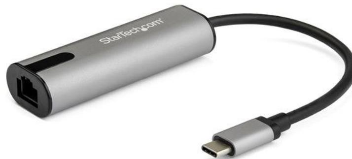
Fügen Sie Ihrem Laptop über einen verfügbaren USB-C-Anschluss einen 2,5-GbE-Netzwerkzugriff hinzu. Dieser USB-3.0-Type-C-auf-Gigabit-Netzwerkadapter ermöglicht Ihnen den Zugriff auf ein kabelgebundenes Ethernet-Netzwerk.
