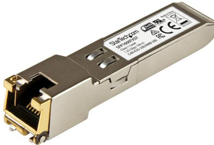
Der SFP1000TXST ist ein MSA-konformer Kupfer-SFP-Transceiver, der für die Arbeit mit 1000BASE-TX-kompatiblen MSA-Switches und -Routern entwickelt, programmiert und getestet wurde. Das SFP-Transceiver-Modul unterstützt eine maximale Entfernung von bis zu 100 m und bietet zuverlässige 1-GbE-Konnektivität über Kupferkabel.
