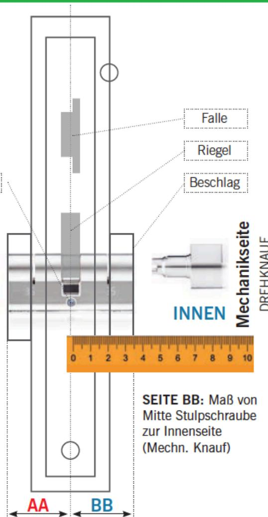
Bei der Bestimmung der benötigten Zylinderlänge muss immer die Stärke des verwendeten Beschlags zur Türstärke addiert werden. Wählen Sie immer das **nächstgrößere Maß** zum gemessenen Maß in **5 mm** Schritten aus. Beginnend immer vom **Grundmaß 30 mm** für Profilzylinder bzw. **32 mm** bei Schweizer Rundzylindern je Seite (**AA/BB**), bis zur maximal möglichen Länge von 70 mm bzw. 72 mm je Seite (**AA/BB**).
