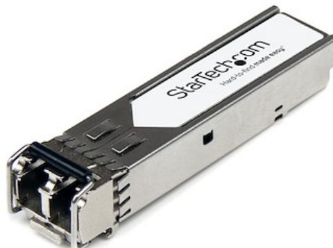
Le J9152A-ST est un module de transceiver SFP+ fibre optique compatible HP J9152A qui a été conçu, programmé et testé pour fonctionner avec des commutateurs et des routeurs de marque HP®. Il vous assure une connectivité de 10 GbE par câble en fibre optique, sur les réseaux compatibles 10GBase-LRM et sur une distance maximale de 200 m.
