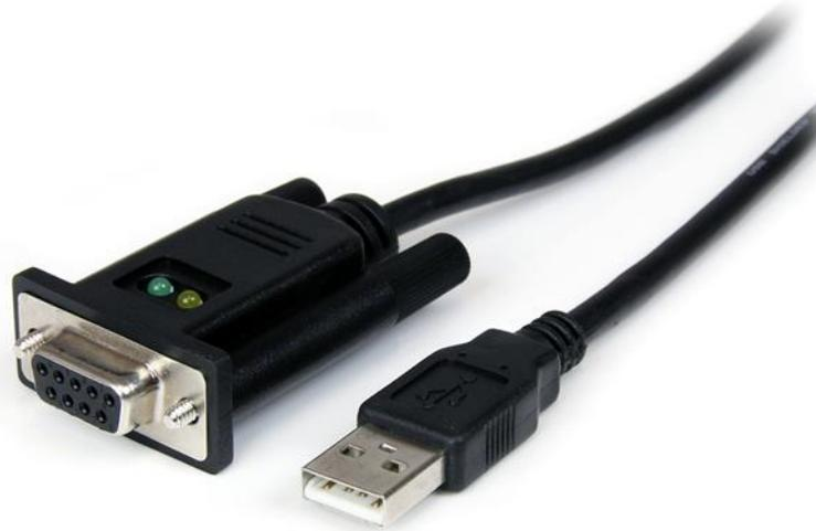
El Cable Adaptador USB a Módem Nulo Serie con FTDI (1 Puerto), ICUSB232FTN convierte un puerto USB 1.1 o 2.0 en un puerto serie RS232 DB9 de módem nulo, resolviendo los conflictos entre un DCE y un DTE fácilmente sin necesidad de emplear adaptadores o cables serie cruzados adicionales.
