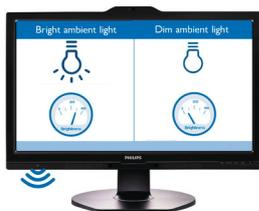
LightSensor utilise un capteur intelligent pour ajuster la luminosité de l'écran en fonction de la luminosité de la pièce, afin d'afficher une image parfaite, avec une consommation d'énergie minime.
