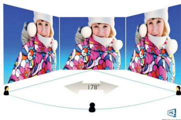
Les écrans IPS utilisent une technologie avancée qui élargit l'angle de vue à 178/178 degrés, ce qui permet de regarder l'écran depuis quasiment n'importe quel angle, même en mode Pivot 90° ! Contrairement aux dalles
