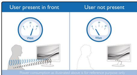
PowerSensor est un « détecteur de personnes » intégré qui transmet et reçoit des signaux infrarouges sans danger lorsque l'utilisateur est présent et réduit automatiquement la luminosité du moniteur lorsque l'utilisateur s'éloigne du bureau. Il permet ainsi de diminuer de 70 % la consommation d'énergie et de prolonger la durée de vie du moniteur.
