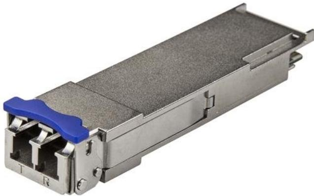
Il prodotto QSFP40GLR4ST è un modulo ricetrasmettitore per fibra compatibile con Cisco QSFP-40G-LR4, progettato, programmato e testato per operare con switch e router a marchio Cisco™. Offre un'affidabile connettività da 40 GbE tramite cavo in fibra per le reti compatibili con 40GBASE-LR4, con distanza massima di 10 km.
