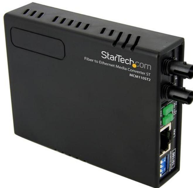
Il convertitore multimediale Ethernet in fibra multimodale ST 10/100 MCM110ST2EU (2 km) crea una conveniente connessione Ethernet-fibra, convertendo in modo trasparente segnali Ethernet da/a 10Base-T o 100Base-Tx e segnali ottici 100Base-Fx per estendere una connessione di rete Ethernet tramite una dorsale in fibra multimodale.
