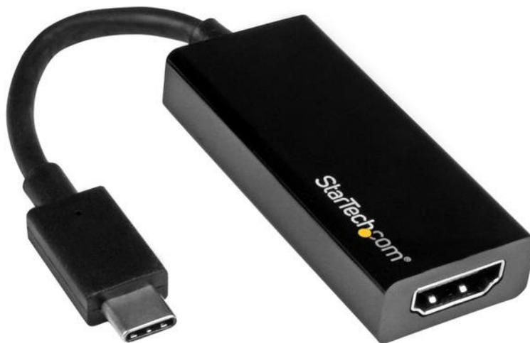
Mit diesem USB-C™-auf-HDMI®-Adapter können Sie HDMI-Video und -Audio von einem USB Type-C™-Gerät, z. B. einem MacBook oder Chromebook-Laptop, ausgeben. Dieser Adapter ist für USB-C-Geräte geeignet, die ein DisplayPort-Videosignal übergeben.
