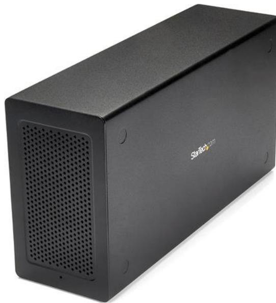
Ce châssis d'extension PCIe Thunderbolt™3 permet d'ajouter une carte PCI Express à votre ordinateur portable ou ordinateur de bureau, par le biais d'une connexion Thunderbolt 3 externe. Le châssis dispose également d'une sortie vidéo DisplayPort qui vous permet de connecter un écran supplémentaire à votre ordinateur portable, et prend en charge l'installation en série Thunderbolt 3 pour élargir encore davantage votre poste de travail.
