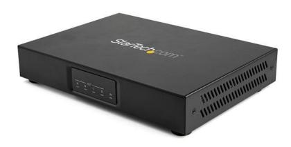
Este controlador de muro multivídeo le permite conectar su fuente de vídeo HDMI a varias pantallas HDMI, compatible con resoluciones Ultra HD y audio envolvente 7.1. Puede utilizar el controlador como multiplicador de vídeo, para distribuir la señal HDMI a cuatro pantallas o combinar el contenido de su fuente de vídeo en cuatro pantallas para crear un muro multivídeo 2x2.
