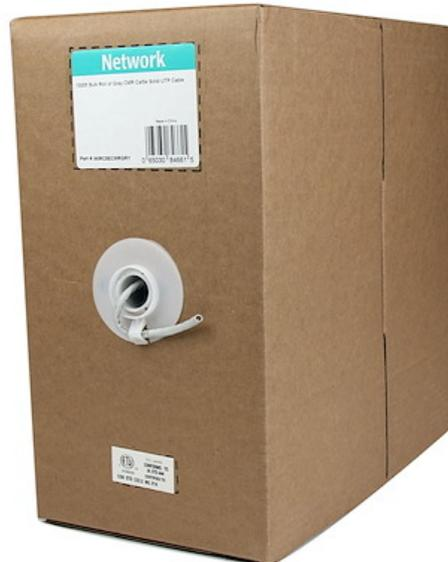
Il cavo UTP solido Cat5e 350 MHz WIRC5ECMRGRY (grigio) ha la classificazione CMR per l'utilizzo in pareti, condutture, soffitti e così via ed è inoltre confezionato in rotoli da 304,8 m. Il cavo presenta una guaina in PVC di colore grigio che assicura flessibilità e resistenza semplificando inoltre la codifica per colore delle connessioni dei cavi di rete.
