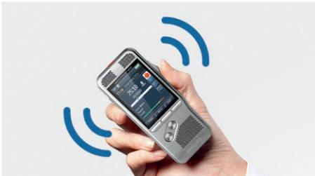
Der integrierte Bewegungssensor erkennt, ob das Gerät auf einem Tisch platziert oder in der Hand gehalten wird und wählt entsprechend das passende Mikrofon für die Aufnahmesituation. Der Bewegungssensor schaltet automatisch auf Standby, wenn das Gerät inaktiv ist. Nehmen Sie das PocketMemo wieder in die Hand, ist es in weniger als einer Sekunde aufnahmebereit.
