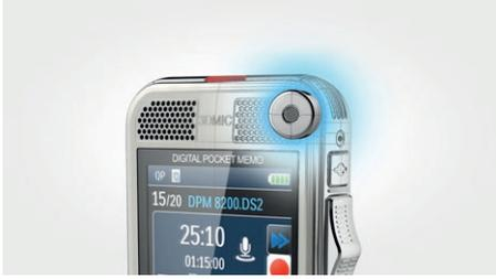
Bei der bahnbrechenden 3D-Mikrofontechnik kommen integrierte Mikrofone zum Einsatz, um stets beste Aufnahmeergebnisse zu gewährleisten: ein omnidirektionales Mikrofon mit 360°-Tonaufnahme für die Aufnahme von mehreren Tonquellen, beispielsweise für Tagungen, und ein für die Sprachaufnahme und erstklassige Spracherkennungsergebnisse optimiertes Richtmikrofon.
