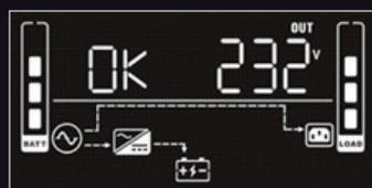
il display a cristalli liquidi di ZINTO fornisce informazioni di base su tensioni di ingresso e uscita, frequenza, autonomia e carico. Il display può ruotare senza l'uso di
