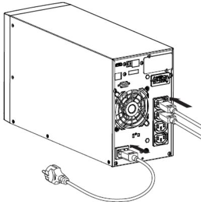
1-Schließen Sie die USV-Eingangsbuchse mit dem Kabel des geschützten Geräts an die Wechselstromquelle an.
