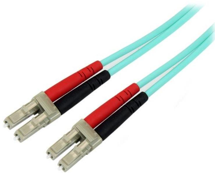
El cable de fibra óptica Aqua, de 3 metros, 850 nm, multimodo con optimización láser (LOMMF), modelo A50FBLCLC3, incluye fibra óptica de 50/125 micrones para la transmisión de datos a alta velocidad, alto ancho de banda, a través de redes de canales de fibra óptica y Ethernet de 10 Gigabits: la solución perfecta para tramos de cables de fibra óptica entre varios conmutadores, concentradores y enrutadores base, así como equipos de red de alta gama.
