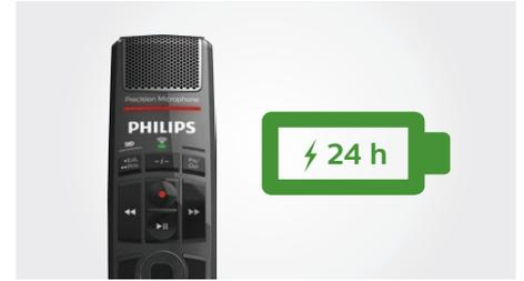
Der leistungsstarke integrierte Li-Polymer-Akku sorgt für bis zu 24 Stunden zuverlässiges Aufnehmen. Über die mitgelieferte Dockingstation lässt sich der eingebaute Akku einfach, drahtlos und extrem schnell in weniger als 3 Stunden aufladen.
