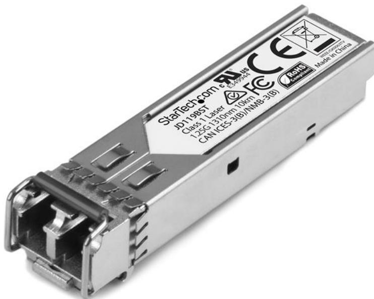
Il prodotto JD119BST è un modulo ricetrasmittitore per fibra compatibile con HP JD119B, progettato, programmato e testato per operare con switch e router a marchio HP®. Offre un'affidabile connettività da 10 GbE tramite cavo in fibra per le reti compatibili con 1000BASE-LX, a una distanza massima di 10 km.
