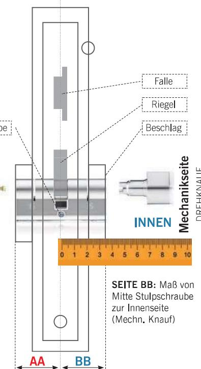
**SEITE AA:** Maß von Mitte Stupschraube zur Außenseite (Elektronikseite)
