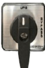
Die Revisionsumgehung ist im serienmäßigen Lieferumfang von XANTO S 6000 enthalten und werkseitig an der Rückseite der USV-Anlage montiert. Für Wartungsarbeiten an der USV-Anlage erfolgt die Umschaltung der Lastversorgung über einen Spezialschalter direkt auf **Netz 2**. Danach kann die USV-Anlage spannungsfrei geschaltet werden.
