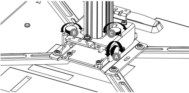
Mit der Rändelschraube ① verschieben Sie das Bild links rechts.
