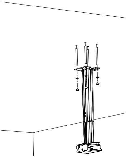
Befestigen Sie die Deckenhalterung viermal mit geeignetem bauseitigem Befestigungsmaterial. Wir empfehlen bei Betondecken die Verwendung von bauaufsichtlich zugelassenen M8 Bolzenanker wie z. B. Tox Bolzenanker S-Fix Pro 1.
