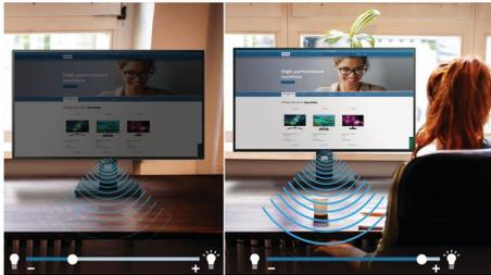
PowerSensor est un « détecteur de présence » intégré qui transmet et reçoit des signaux infrarouges inoffensifs pour déterminer la présence de l'utilisateur et réduire automatiquement la luminosité du moniteur lorsqu'il s'éloigne du bureau. Il permet ainsi de diminuer de 70 % la consommation d'énergie et de prolonger la durée de vie du moniteur.
