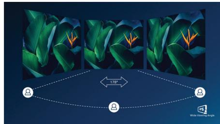
Les écrans IPS utilisent une technologie avancée qui élargit l'angle de vue à 178/178 degrés, ce qui permet de regarder l'écran depuis quasiment n'importe quel angle, même
