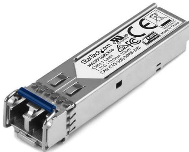
El modelo MASFP1GBLX10 es un módulo transceptor por fibra óptica compatible con el modelo MA-SFP-1GB-LX10 de Cisco Meraki, diseñado, programado y probado para su funcionamiento con enrutadores y conmutadores de la marca Cisco Meraki™. Ofrece conectividad 1GbE (100Mbps) fiable a través de cable de fibra óptica para redes compatibles con 1000BASE-LX, con una distancia máxima de hasta 10km.
