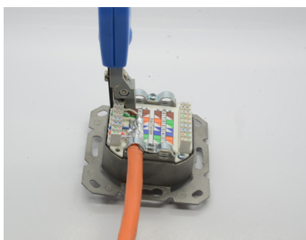
Terminate the wires with LSA impact tool Aufschalten der Aderpaare mit LSA-Werkzeug Fixer les brins de câbles à l'aide d'un outil de raccordement
