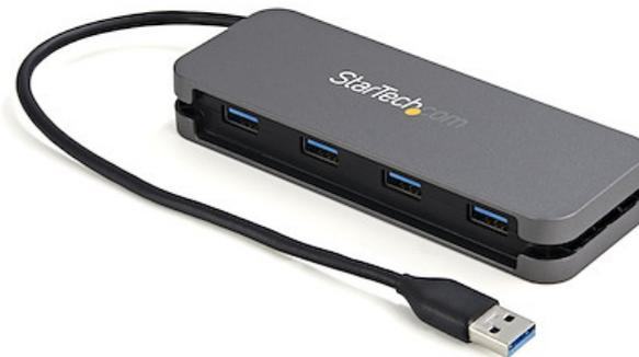
Mit diesem USB Hub mit 4 Anschlüssen können Sie vier SuperSpeed USB 3.2 Gen 1 (5 Gbit/s) Peripheriegeräte an Ihren USB-A Laptop oder Computer anschließen. Dies ist eine ideale Lösung, um einem Gerät mit begrenzten USB-Anschlüssen weitere hinzuzufügen. Er verfügt über einen Kabelmanager zum Wickeln, dadurch können Sie das integrierte Kabel einfach verstauen und somit mobil bleiben.
