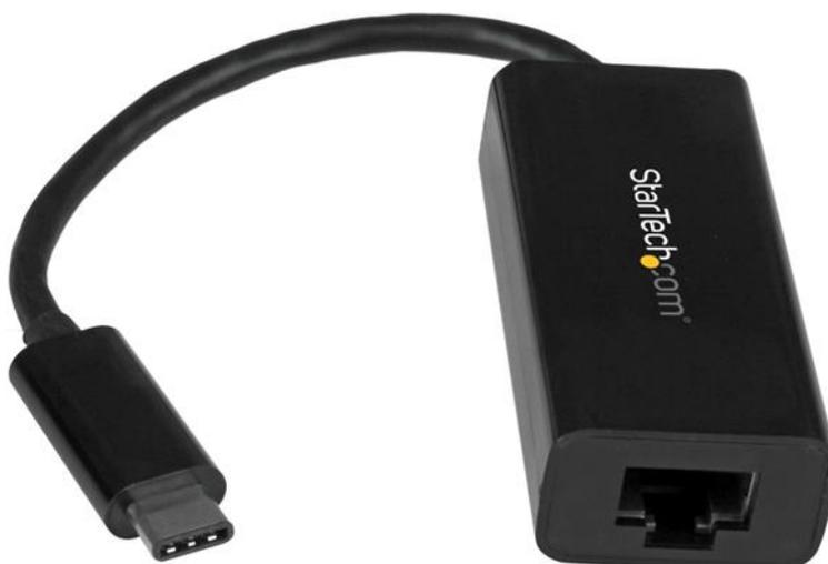
Désormais, rien de plus facile que de vous connecter à un réseau Gigabit par le port USB-C™ ou Thunderbolt™ 3 de votre ordinateur portable ou de bureau. Cet adaptateur réseau Gigabit Ethernet (GbE) assure une connexion fiable sans installation de pilotes. Il est prêt à l'emploi, et la prise en charge native du pilote permet sa configuration rapide.
