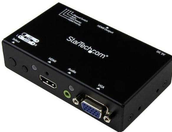
Lo switch automatico HDMI e VGA VS221VGA2HD consente di collegare una sorgente audio/video HDMI e VGA allo stesso display o proiettore HDMI ed eseguire la commutazione automatica o manuale tra le sorgenti video da visualizzare. Questo switch A/V multi-ingresso supporta risoluzioni video fino a 1920x1200 (1080p) e comprende l'hardware di montaggio per un'installazione ordinata e professionale.
