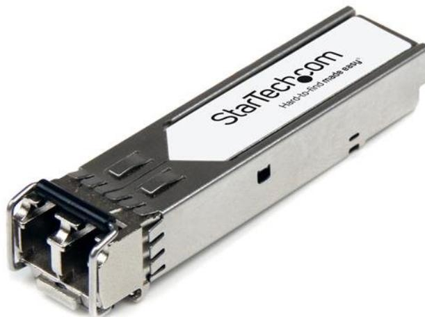
Il SFP-10G-LR-40-ST0-ST0-ST è un modulo ricetrasmittitore SFP+ in fibra compatibile con Cisco SFP-10G-LR-40-ST0-ST0 progettato, programmato e testato per funzionare con switch e router prodotti da Cisco®. Offre una connettività affidabile 10 GbE su cavo in fibra per le reti compatibili con 10GBase-LR a una distanza massima di 40 km.
