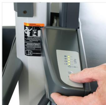
La spia luminosa led e l'allarme di batteria scarica favoriscono l'operatività, permettendo di tenere sempre sotto controllo la durata della batteria.
