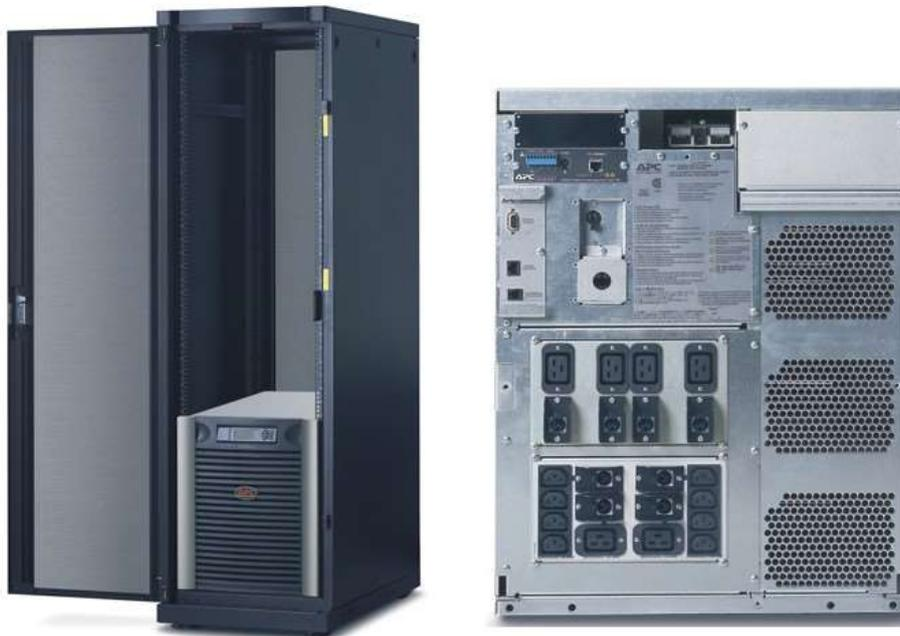
Anmerkung: Die Anlage kann wahlweise 3phasig Eingang/1phasig Ausgang oder 1phasig Eingang/1phasig Ausgang angeschlossen werden. Auf der Rückseite befinden sich 8x IEC320-C13 und 6x IEC320-C19 Kaltgerätebuchsen, die bei 1phasigem Ausgangsbetrieb direkt genutzt werden können
