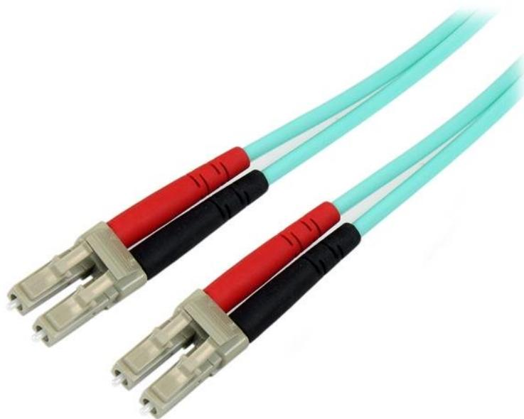
Il cavo Aqua in fibra multimodale ottimizzato a laser 3 m 850 nm (LOMMF) A50FBLCLC3 presenta una fibra da 50/125 micron per trasmissioni di dati ad alta velocità ed elevata larghezza di banda attraverso le reti 10 Gigabit Ethernet e Fiber Channel: la soluzione ideale per la posa di cavi in fibra tra switch di dorsali, hub e router oltre che tra dispositivi di rete di livello superiore.
