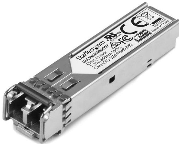
Il prodotto GLCSXMMRGDST è un modulo ricetrasmittitore per fibra compatibile con Cisco GLC-SX-MM-RGD, progettato, programmato e testato per operare con switch e router a marchio Cisco®. Offre un'affidabile connettività da 1 GbE tramite cavo in fibra per le reti compatibili con 1000BASE-SX, a una distanza massima di 550 m.
