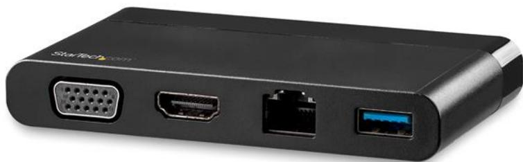
Dieser USB-C-Multiport-Adapter mit HDMI und VGA ist ideal für mobile Mitarbeiter und sorgt für eine flexible Videoausgabe. Er funktioniert wie vier Adapter in einem, mit HDMI- oder VGA-Anschlüssen, einem Gigabit-Ethernet-Anschluss und einem USB-3.0-Anschluss - all das über eine einzige Verbindung am USB-C-Anschluss Ihres Laptops. Darüber hinaus bietet er ein verstaubares Kabel für besseres Kabelmanagement und einfacheres Reisen.
