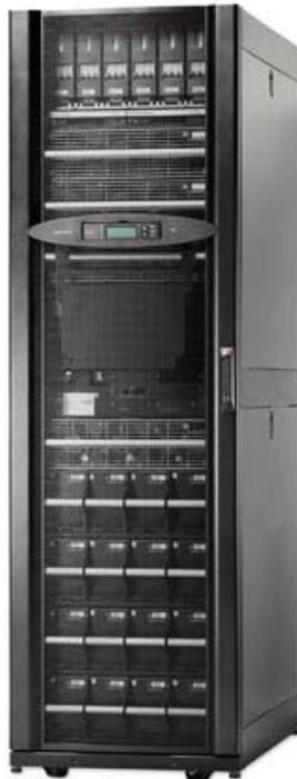
Anmerkung: Abbildung zeigt die Variante mit 3x 16kW Modulen, mit 4 Batteriesträngen und eingebauten Sicherungsautomaten bzw. Elektro-Verteilung im oberen Bereich der USV. Die Sicherungsautomaten sind optional zu bestellen und als 1- bzw. 3-phasige Ausführungen lieferbar.
