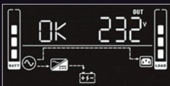
Das Flüssigkristalldisplay von ZINTO liefert grundlegende Informationen zu Ein- und Ausgangsspannung, Frequenz, Überbrückungszeit und Last. Zum ergonomischen Ablesen kann das Display werkzeuglos gedreht und der Installationsart der USV-Anlage als Tower oder im Rack angepasst werden.
