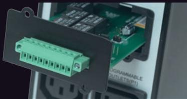
Für die Kommunikation mit IBM AS400-Server oder zur Einbeziehung in industrielle Schaltanlagen kann XANTO um eine optionale AS400- / Relaiskarte ergänzt werden. An ihrer Klemmleiste stehen potenzialfreie Meldekontakte (via Relais) folgender Funktionen zur Verfügung: Normalbetrieb, Batteriebetrieb, Batteriespannung niedrig, Bypassbetrieb, Standbybetrieb, Sammelstörung. Über einen zusätzlichen Eingangskontakt kann die ferngesteuerte USV-Abschaltung erfolgen.
