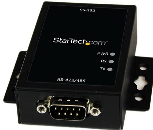
Le convertisseur série industriel RS232 vers RS422/485 IC232485S est un adaptateur bidirectionnel qui vous permet de transformer un signal de données RS232 en RS485 (2 ou 4 fils) ou RS422 (et vice-versa), avec la prise en charge de débits en baud jusqu'à 921,6 Kb/s.
