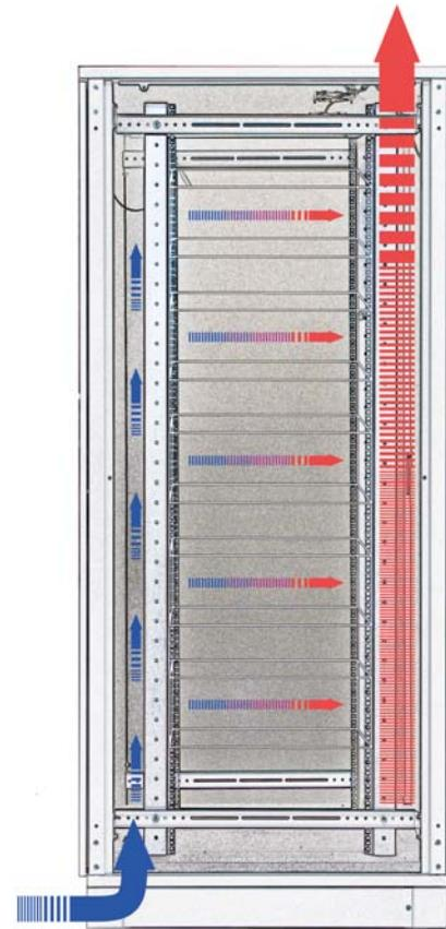
■ Der Warmluftausstoss der Server im hinteren Bereich des Akustikschrankes wird von den Ventilatoren im Dachmodul wirkungsvoll aus dem Schrank transportiert.
