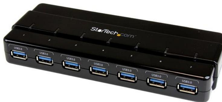
Le hub USB 3.0 ST7300USB3B vous permet d'ajouter sept ports USB 3.0 externes à un ordinateur à partir d'une seule connexion hôte USB 3.0.
