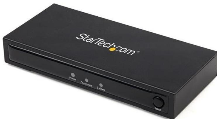
Questo convertitore S-Video o composito a HDMI con audio, oltre a supportare l'audio RCA L/R, consente di collegare un dispositivo S-Video o composito analogico al monitor HDMI o alla televisione.
