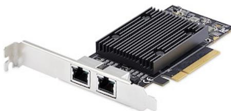
Diese PCIe-Netzwerkkarte ermöglicht es, zwei 10GBase-T-Ports zu Ihrem Server oder Ihrer Workstation hinzuzufügen und bietet eine kostengünstige Lösung für bandbreitenintensive Anwendungen. Sie unterstützt 10GbE über Cat-6 Kabel bis zu 55 Meter und über Cat-6A Kabel bis zu 100 Meter.
