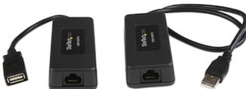
L'extendeur USB 1.1 USB110EXT2 vous permet de prolonger une connexion USB 1.1 sur une distance pouvant atteindre 40 mètres à l'aide d'un câblage UTP Cat5 ou Cat6 standard, dépassant ainsi la limitation normale de 5 m des périphériques USB 1.1 et permettant de stocker le système informatique à distance, dans un endroit sûr.
