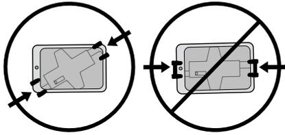
VORSICHT! Befestigen Sie das Tablet NICHT mit den Halterungen an den Seiten oder den Enden des Tablets. Bringen Sie die Halterungen nur an den Ecken des Tablets an. Die Nichtbeachtung dieser Anweisungen führt zu einer ungesicherten Montage und kann dazu führen, dass das Tablet aus der Halterung fällt, was zu einer möglichen Beschädigung des Geräts führt.
