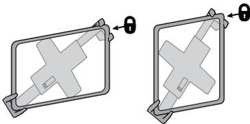
Wichtig! Die Verriegelung stets an der Oberseite positionieren. Ohne Verriegelung an der Oberseite, könnte das Tablet sich durch Anstoßen lösen, was zu einer möglichen Beschädigung des Geräts führt.
