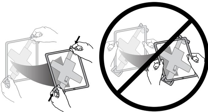
Wichtig! Halten Sie die Handgriffe, wenn Sie das befestigte Tablet bewegen. Ein Nichtfesthalten könnte dazu führen, dass das Tablet sich vom Halter löst und herunterfällt, was zu möglichen Geräteschäden führt.
