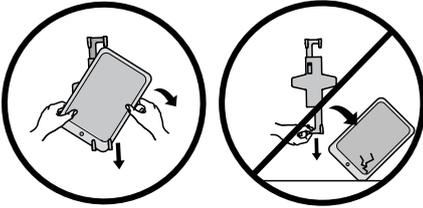
VORSICHT! Halten Sie das Tablet fest, wenn Sie es aus der Halterung entfernen. Ziehen am Haltearm ohne Festhalten des Tablets wird dazu führen, dass das Table herausfällt, was zu einer möglichen Beschädigung des Geräts führt.
