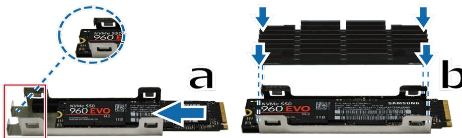
**Anmerkung:** Entfernen Sie vor Schritt 3b die Trennfolie von der Unterseite des Kühlkörpers.
