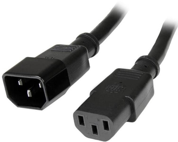
La prolunga del cavo di alimentazione per computer PDU da 1 m PXT1001M presenta un connettore (femmina) di alimentazione del computer C13 e un connettore (maschio) di alimentazione con cappuccio che permettono di collegare il server a UPS o PDU dotate di C13.
