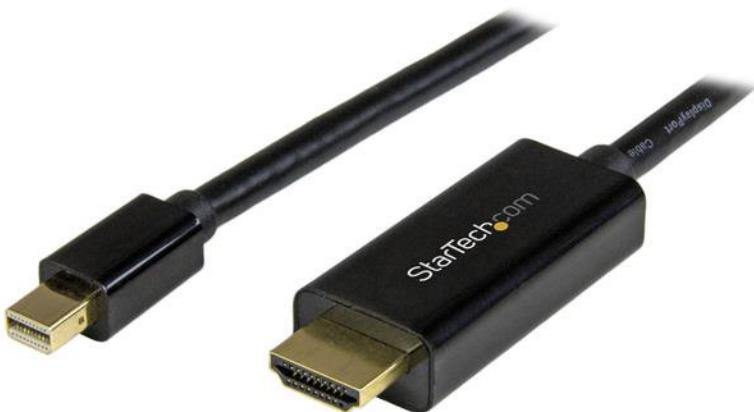
Questo cavo adattatore Mini DisplayPort™ a HDMI® da 3 m consente il collegamento da un computer laptop MacBook, Ultrabook™ o Microsoft® Surface™ Pro con tecnologia mDP a un display o a un proiettore HDMI. L'adattatore passivo supporta risoluzioni video fino a Ultra HD 4K ed è compatibile con la tecnologia Thunderbolt™ se collegato direttamente a una porta I/O che supporta la tecnologia DisplayPort tramite Thunderbolt.
