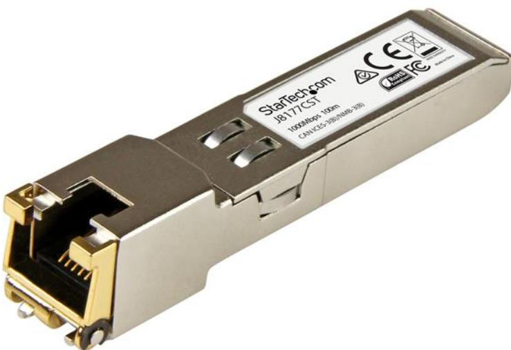
El modelo J8177CST es un módulo transceptor por cobre, compatible con el modelo J8177C de HP, diseñado, programado y probado para su funcionamiento con enrutadores y commutadores de la marca HP®. Ofrece conectividad fiable a 1GbE a través de cableado de cobre, para redes compatibles con 1000BASE-T, a una distancia máxima de hasta 100m.
