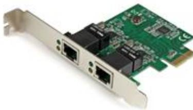
La scheda di rete PCI Express Gigabit a due porte ST1000SPEXD4 permette di aggiungere due porte Gigabit Ethernet a un client, server o workstation mediante un solo slot PCIe. Ogni porta fornisce una rete Ethernet da 10/100/1000 Mbps ed è interamente compatibile con gli standard IEEE 802.3/u/ab.
