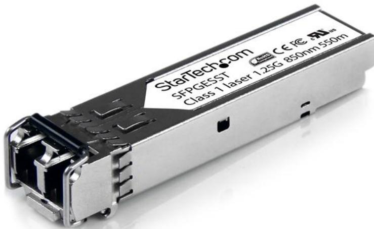
El modelo SFPGESST es un módulo transceptor por fibra óptica, compatible con el modelo SFP-GE-S de Cisco, diseñado, programado y probado para su funcionamiento con enrutadores y conmutadores de la marca Cisco®. Ofrece conectividad fiable a 1GbE a través de cableado de fibra, para redes compatibles con 1000BASE-SX, a una distancia máxima de hasta 550m.
