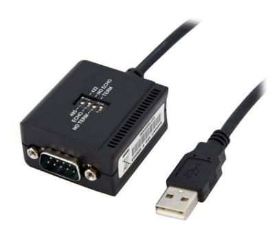
El cable adaptador de serie a USB RS422/485 profesional de 1,8 metros, modelo ICUSB422, con retención de puerto COM, permite la conexión de dispositivos serie RS422 o RS485 con un ordenador equipado con USB. El adaptador incluye un conector serie macho de 9 pines (DB9), así como controles para conmutador DIP que facilitan la configuración de los puertos, además de que requieren poco software.
