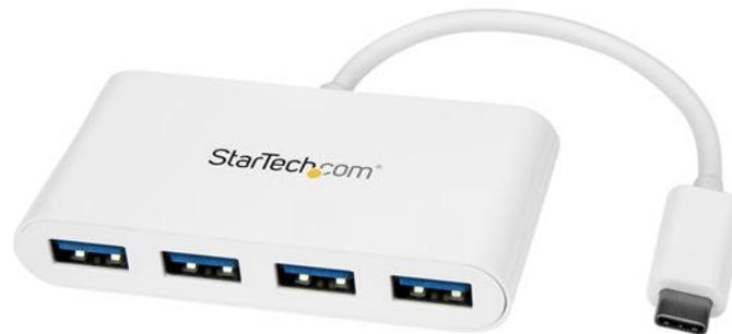
Este concentrador portátil USB 3.0 amplía la conectividad de su ordenador portátil o de sobremesa, ya que añade cuatro puertos USB Type-A, a través de un solo puerto USB Type-C™ o Thunderbolt™ 3. Y dado que ofrece alimentación por bus USB, no es necesario conectarlo a un adaptador de alimentación externo, lo cual resulta práctico al viajar/desplazarse y evita marañas de cables alrededor de estaciones de trabajo.
